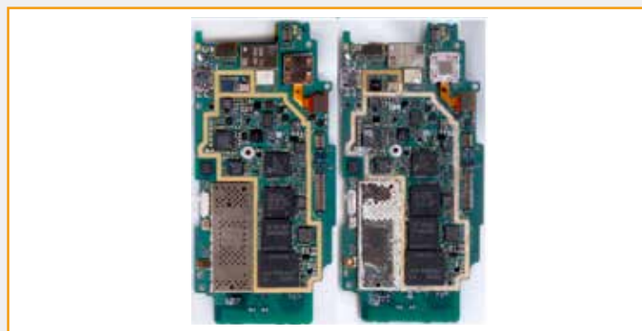
Moederbord van een mobiele telefoon zonder vochtschade (links) en met vochtschade (rechts)
